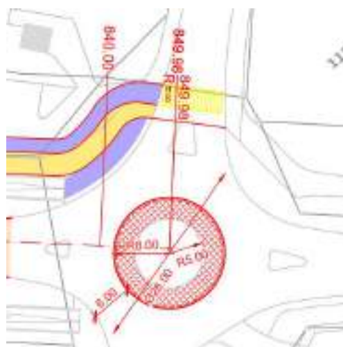
Figure 13 : raccordement à l'autre extrémité du projet au niveau du giratoire.
