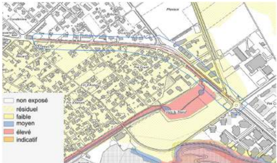
Figure 3: Dangers hydrologiques liés aux cours d'eau et chute de blocs. 1
