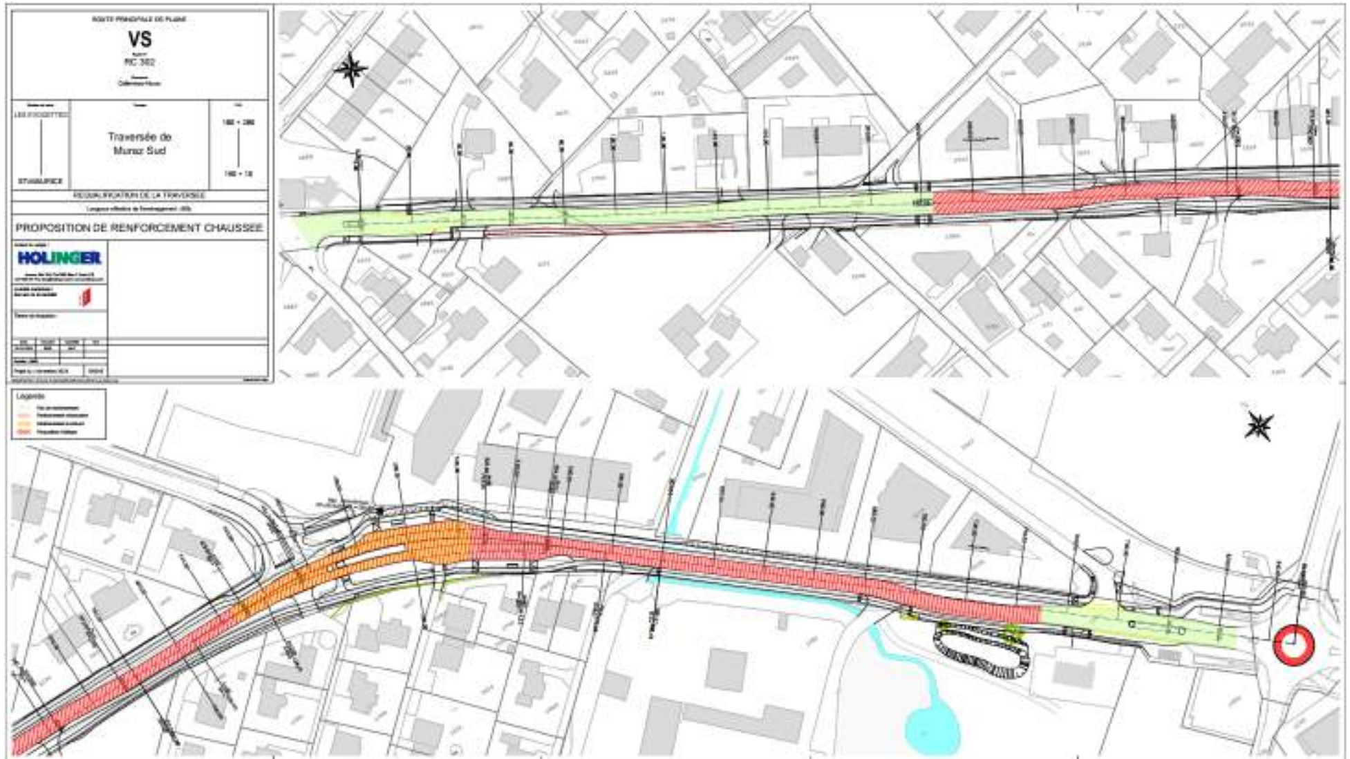
Figure 4 : différentes sections avec renforcement prévu (en rouge et orange) et sans renforcement prévu (en vert).
