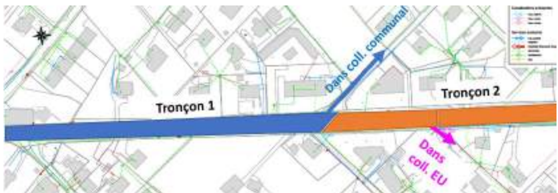
Figure 2: évacuation actuelle des eaux claires, tronçons 1 et 2.
